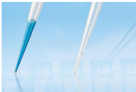
2種類のチップを使って溶液を吸引、すぐに排出した時の比較 左：ノーマルチップ 右：ローリテンションチップ
