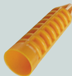
アダプターを用いることで 15 mL遠沈管用の 遠心機ローターに対応
